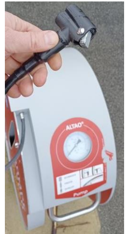
Embout plastique endommagé
